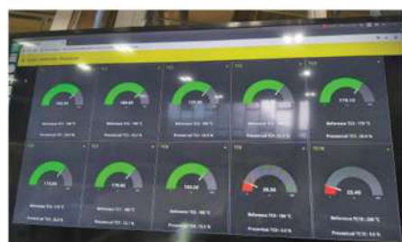
Spremljanje delovanja ekstruzijske linije preko vgrajenih senzorjev.
